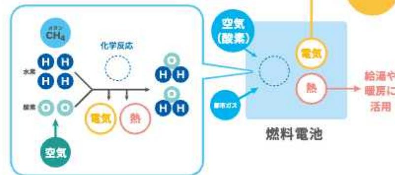
**燃料電池とは、「水の電気分解」と逆の原理を利用して電気をつくる「発電装置」のこと**
